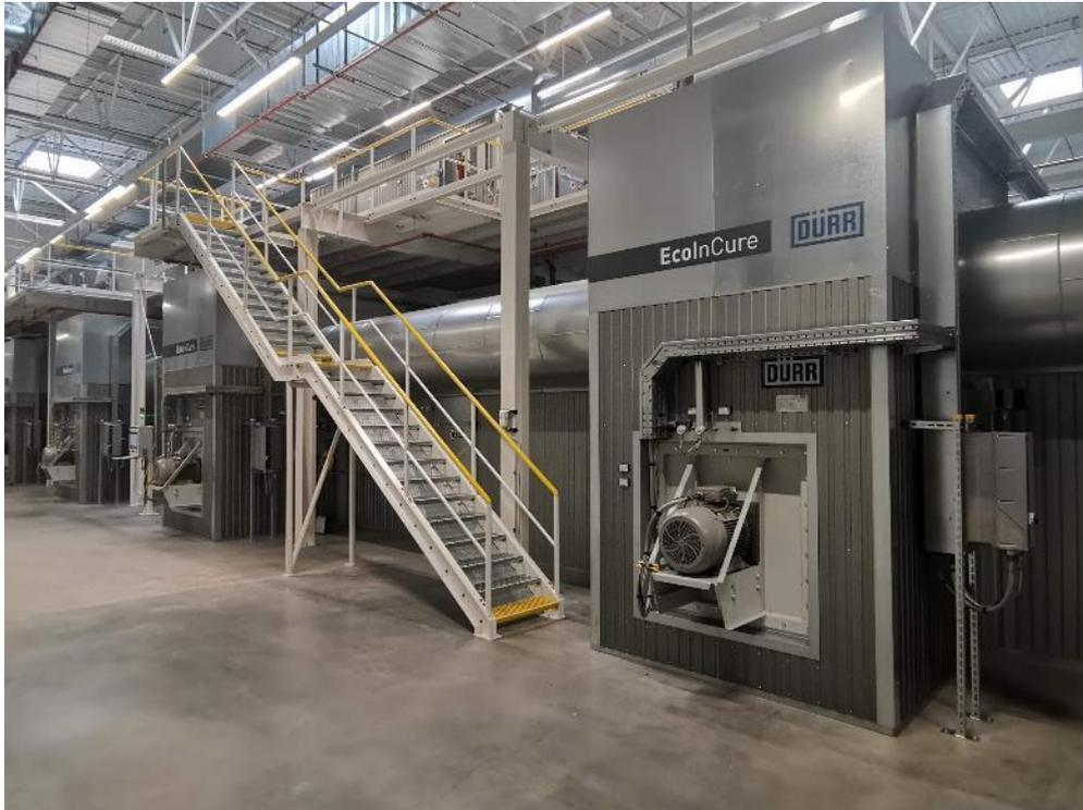
**Figure 3** : Un agencement réduisant l'encombrement : EcoInCure diminue de moitié la longueur de l'étuve par rapport aux étuves conventionnelles.
