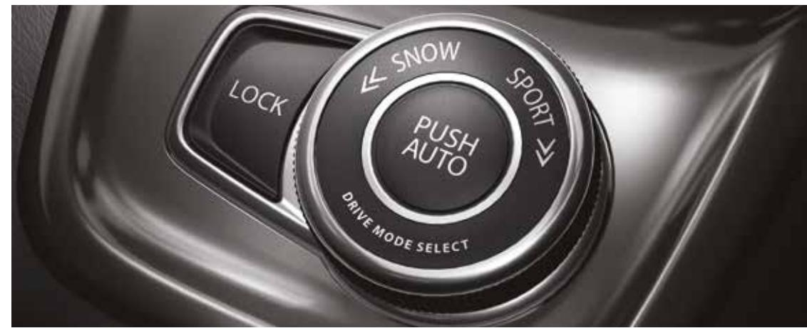
Quels que soient le type de terrain ou de conditions météorologiques, le système ALLGRIP de Suzuki s'adapte à toutes les situations. Il se décline en trois dispositifs : **ALLGRIP AUTO** : il garantit au conducteur une totale tranquillité d'esprit grâce à une transmission intégrale à visco-coupleur, qui permet de transférer automatiquement le couple sur les roues arrière lorsque une perte d'adhérence est détectée sur les roues avant. Il est proposé sur l'Ignis.
