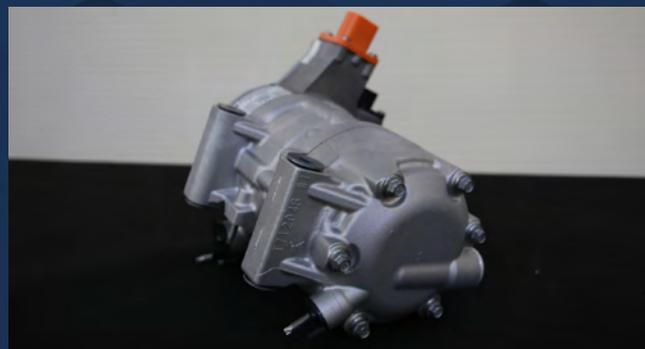
**Compresseur de climatisation électrique** Puissance 5kW / 300V
