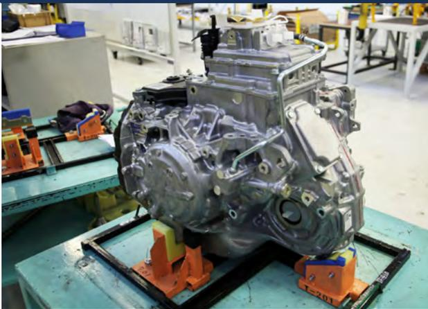
Un **moteur électrique** doté d'une puissance de 80Kw/ 110ch intégré à la **boîte de vitesses automatique 8 rapports EAT8**.
