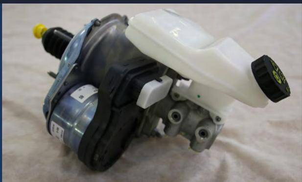
**Un système de freinage récupératif** à assistance électrique (« i-booster ») permet aux moteurs électriques de récupérer l'énergie disponible au cours des phases de freinage et de décélération. 10% d'autonomie en moyenne est ainsi récupérable grâce à un transfert de l'énergie mécanique en énergie électrique ensuite stockée dans la batterie.
