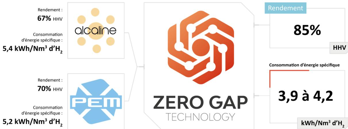
La membrane GEN-AEM® améliore l'efficacité énergétique permettant d'atteindre 85% de rendement HHV (High Heating Value) à une intensité surfacique jamais atteinte à ce jour sur un électrolyseur alcalin, soit 0,7 A/cm<sup>2</sup> alors que la moyenne des systèmes concurrents atteint 0,30 A/cm<sup>2</sup>.
