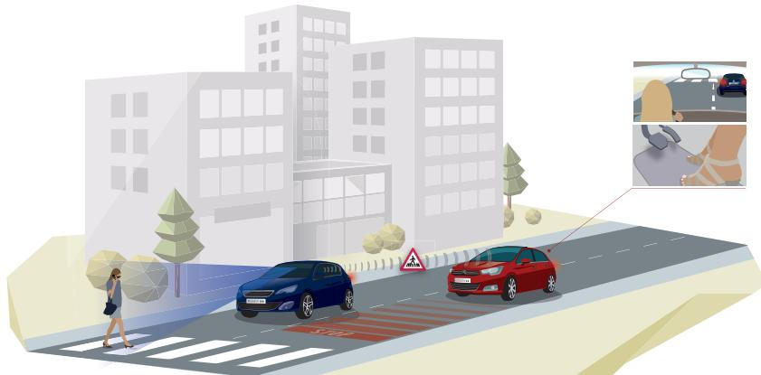
Mon véhicule communiquera aussi avec son environnement (**Car-to-Infrastructure**). En cas d'accident d'un véhicule sur l'autoroute, l'information pourra ainsi être relayée sur les écrans des autres véhicules et sur les panneaux autoroutiers.
