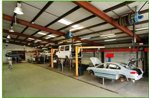
L'étape de dépollution-démontage dure entre 20 et 40 minutes. Avec ses cinq postes de démontage, la chaîne peut traiter jusqu'à 125 voitures par jour.
