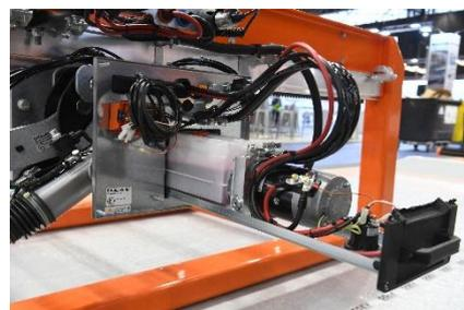
Solide, précis et taillé pour la cadence : dotés de quatre vérins, deux pour le levage et deux pour l'inclinaison, et d'un système de rétraction par crémaillère, la configuration de la gamme DH - SMR assure un cycle complet.
