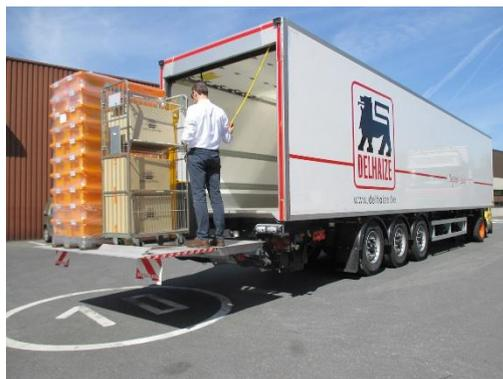
Standard sur la gamme PL DHOLLANDIA depuis 2012 et les premiers hayons galvanisés, après 12 ans d'exploitation, le traitement anticorrosion signé Dhollandia affiche d'excellents résultats : traces de corrosion inexistantes et fonctionnement produit optimal.
