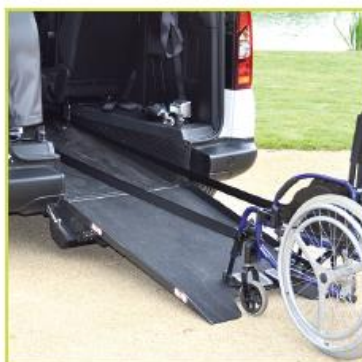
Large décaissement de la partie arrière recouvert d'antidérapant et insonorisé
