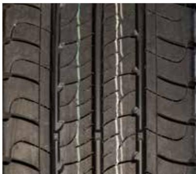
Le dessin de la bande de roulement a une incidence importante sur la tenue de route, mais aussi sur la résistance à l'aquaplaning et sur les distances de freinage. Une bonne maîtrise de la surface de gomme en contact avec la chaussée permet également de contrôler les bruits de roulement, ce qui représente une caractéristique très importante lorsqu'il s'agit de véhicules de
