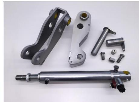
Les plans actuels prévoient aussi de traiter les vérins hydrauliques en finition zinc-nickel. En plus de l'amélioration de la qualité de finition, l'incorporation de vérins hydrauliques traités zinc-nickel dans des bâtis galvanisés à chaud mènera à plus d'homogénéité de couleurs, et donc à un rendu plus esthétique.
