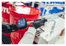
Christophe Lacroix, Directeur et l'innovation et du développement durable chez Motul, précise : « Nous avons développé un fluide diélectrique capable de dissiper la chaleur et d'isoler les cellules de la batterie. Notre démarche vise trois avantages clairs : des batteries plus sûres, avec moins de risques d'incendie, et des batteries plus durables, avec des possibilités de charge plus rapide. »
