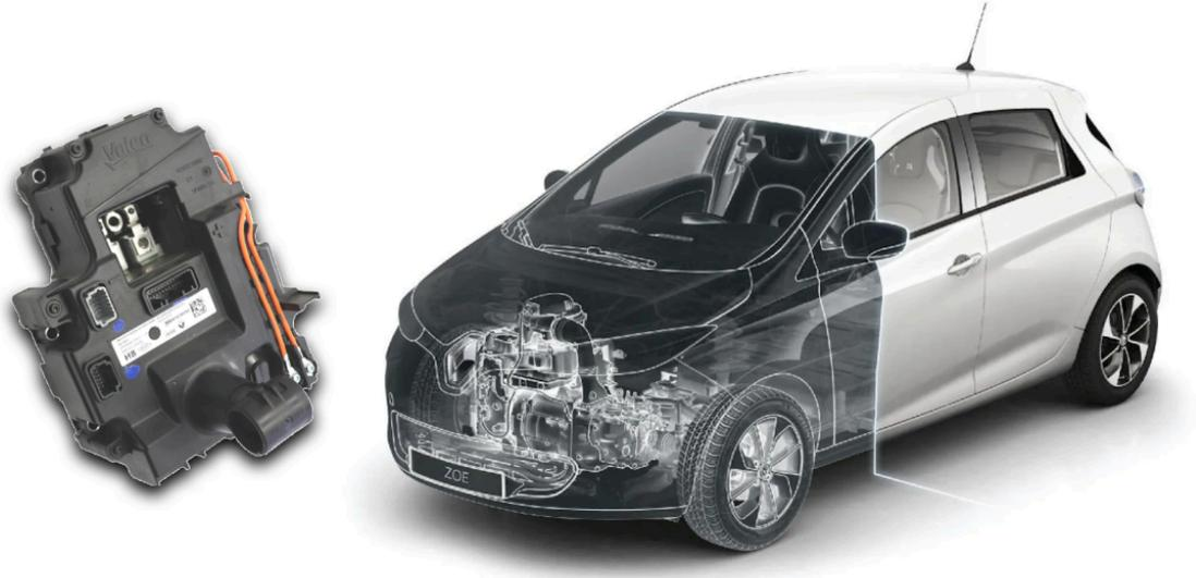
*L'onduleur est un composant clé de l'électronique de puissance : il convertit l'énergie de la batterie en courant alternatif pour alimenter le moteur électrique du véhicule.*
