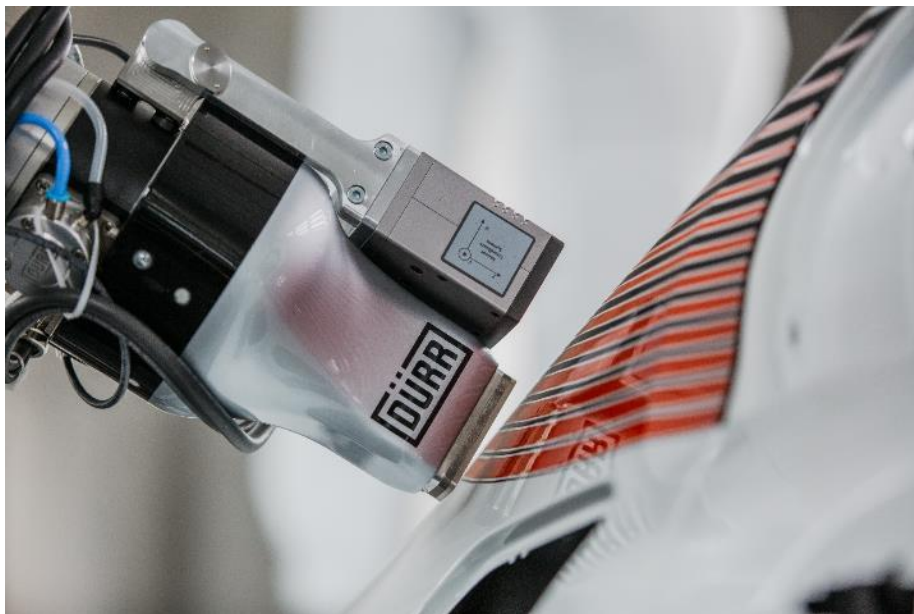
Figure 2 : Ni masquage ni overspray : EcoPaintJet Pro peut peindre des surfaces verticales
