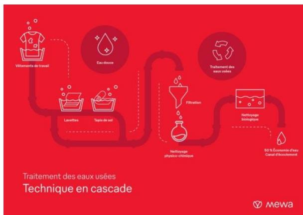
La technique « en cascade » réduit la consommation d'eau jusqu'à 50 % par rapport aux systèmes traditionnels. (Photo : Mewa)
