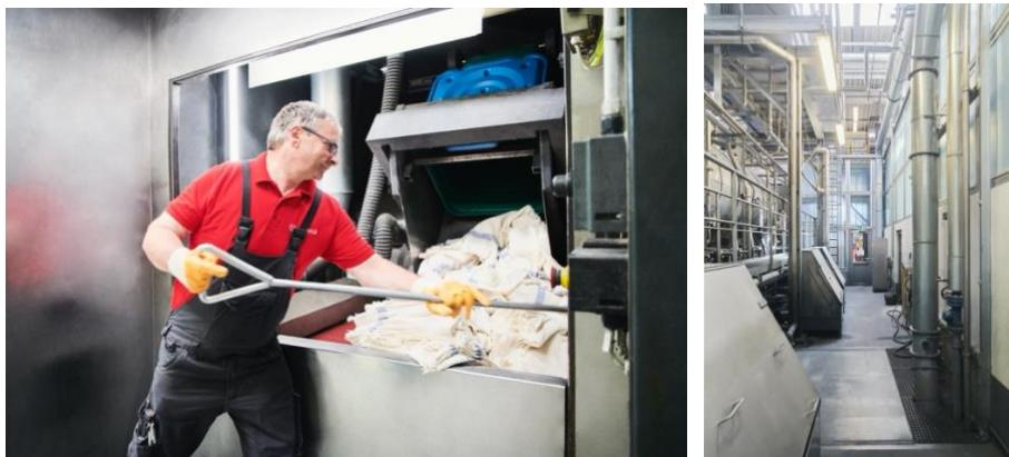
Les lavettes sont lavées dans des installations de lavage ultramodernes. La chaleur générée est utilisée pour chauffer l'eau et les locaux de l'entreprise.
