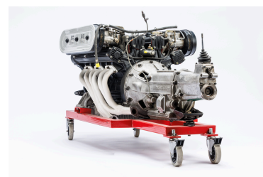
Moteur et boîte de vitesses Lamborghini Espada
