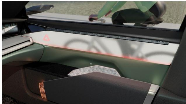
Le Light Tile for Transparent Door de FORVIA est un dispositif qui permet de transformer les panneaux de porte en agrandissant virtuellement des fenêtres. En cas de risque détecté avant l'ouverture de la portière, il affiche des informations afin d'aider les occupants à réagir plus vite dans l'obscurité ou des conditions critiques où la vision
