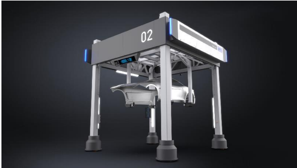
2 ème photo : Le transporteur à guidage automatique (AGC) appelé ProLiner, déplace des modules à structure métallique à l'aide de potences intégrées, sur la base de l'électrification par batterie.
