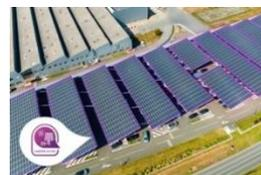
offre complète, qui répond à la réglementation en vigueur imposant l'installation d'ombrières photovoltaïques sur les parcs de stationnement d'une superficie supérieure ou égale à 1500 m<sup>2</sup>. Couplée à l'offre PUR-ELEC, Altens assure ainsi la production, la distribution d'électricité « verte » et éventuellement son stockage par des batteries stationnaires.
