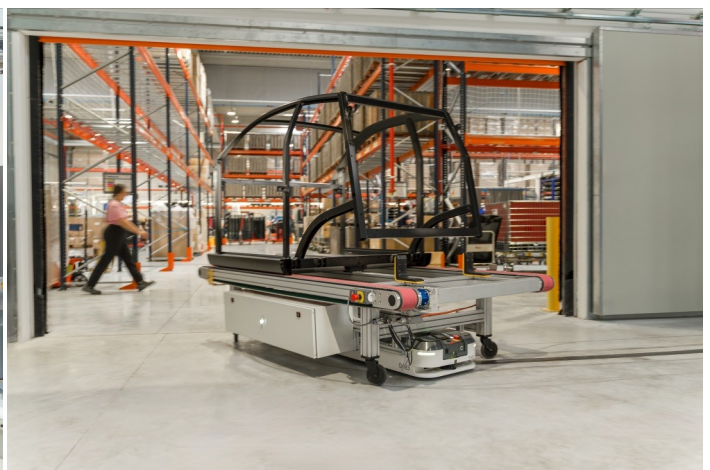
Acheminement des châssis grâce au robot AGV
