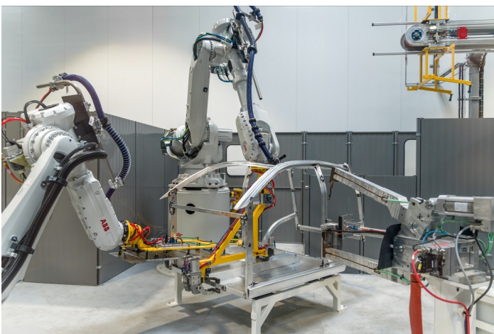
Assemblage des châssis entièrement robotisé
