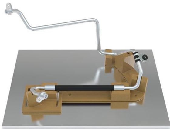
*Pour garantir la précision dimensionnelle, les tuyaux et les combinaisons tuyaux-tuyaux sont assemblés à l'aide de gabarits*
