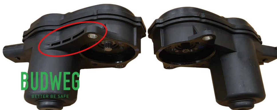
Renforcement de la structure des boîtiers en plastique Budweg (à gauche) vs la concurrence (à droite)
