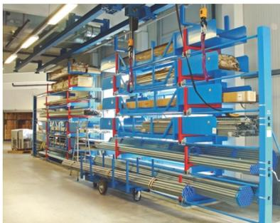
**SEGEMA renforce son offre en matière de solutions de stockage pour charges longues et présente une nouvelle version optimisée de sa gamme de racks cantilever pour le stockage de tubes et de barres avec extraction par manivelle.**
