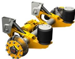
Le nouvel essieu **SAF TRAKr** sera présenté sur le salon. Il utilise un générateur haute tension de 400V pour récupérer l'énergie électrique. Il est particulièrement adapté aux véhicules frigorifiques, car il évite ou réduit le bruit et les émissions d'échappement du groupe frigorifique et prolonge sa durée de vie.
