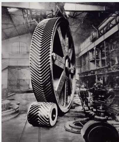
Système d'engrenages aux dents en V renversé Crédits photo : Citroën Communication
