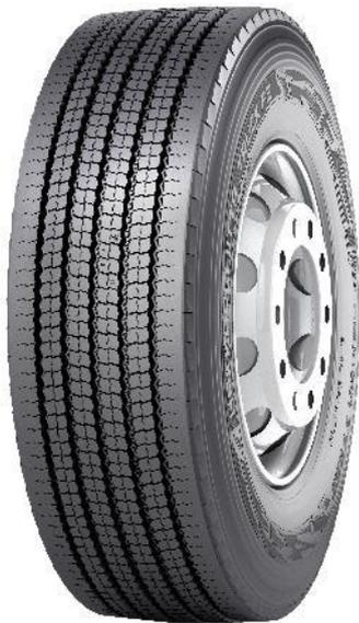
Le pneu Hakkapeliitta Truck F2 présente de nouvelles innovations. Un nouveau système Spiral Sipe (lamelles en spirale) qui permet au pneu de bénéficier d'un excellent degré d'adhérence même lorsque le pneu commence à s'user. Les rainures de la bande de roulement en forme de zigzag, permettent aux cailloux coincés de s'éjecter plus facilement et de protéger les rainures principales améliorant ainsi la durée de vie du pneu et facilitant le rechapage.
