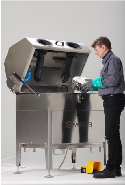
**La nouvelle fontaine de dégraissage à haute pression de Mewa nettoie les pièces dans une chambre hermétique avec une pression pouvant atteindre 80 bars. Photo : Mewa**
