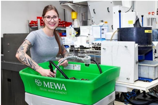
*Légende : La fontaine de dégraissage Bio-Circle nettoie les petites pièces couvertes d'huile ou de graisse avec un traitement à base de microorganismes. Régulièrement entretenue par MEWA, elle est toujours prête à l'emploi.*
