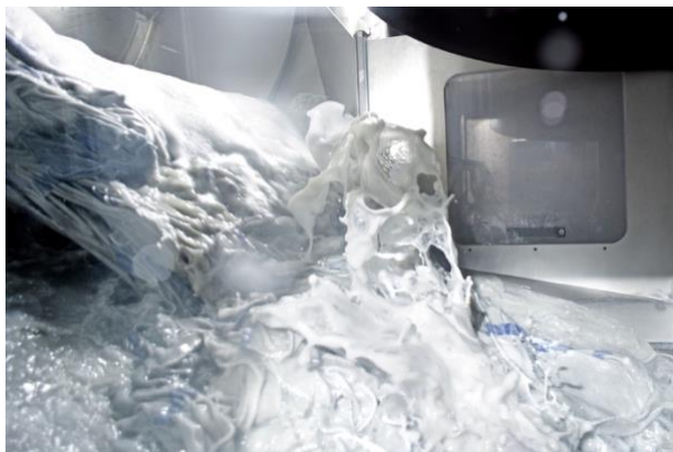
Les lavettes sont lavées dans un système automatisé (Photos : MEWA)
