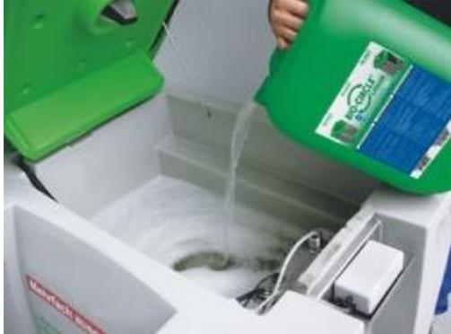
La fontaine de dégraissage MEWA *Bio-Circle* garantit un nettoyage écologique des outils et des pièces métalliques dans les ateliers et les installations de production. Le liquide de nettoyage à base d'eau contient des microorganismes naturels et protège la peau et l'environnement.
