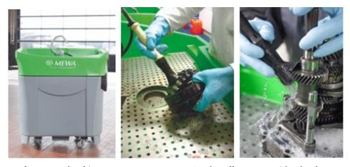
La fontaine de dégraissage MEWA Bio-Circle offre une méthode de nettoyage douce et respectueuse de l'environnement pour éliminer les huiles et les graisses. Elle est proposée avec la prestation en service complet de MEWA. Photos : MEWA
