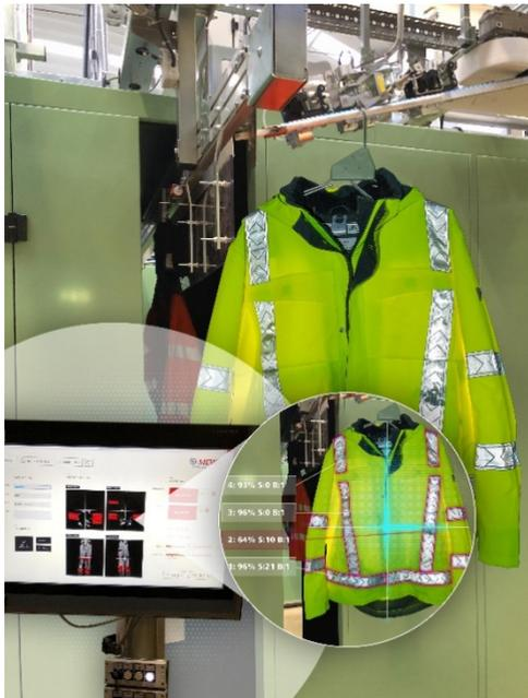
Le contrôle automatique des fonctionnalités de sécurité, développé par MEWA et l'Institut Fraunhofer, permet de s'assurer précisément que les vêtements de signalisation sont encore sûrs, lavage après lavage.
