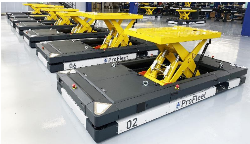
Figure 1 : AGV ProFleet pour l'assemblage final, conçu pour Lotus par CPM, une société du groupe Dürr
