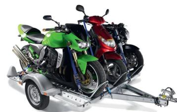
La *Châssis Premium 145* conçue pour transporter 1, 2 ou 3 motos ou scooters. Elle est modulable et s'adaptera parfaitement aux 3 configurations possibles (L200cm x l145cm)
