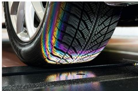
Lorsque le véhicule passe sur le système de mesure, TTM mesure instantanément la profondeur de la bande de roulement avec une grande efficacité :
