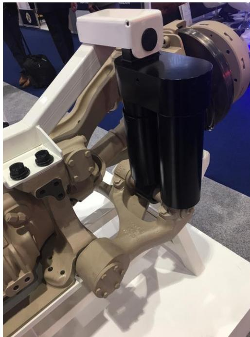
KONI a récemment étendu son champ d'application et a intégré des ressorts pneumatiques et des amortisseurs en unités autonomes, comme alternative aux ressorts métalliques et aux amortisseurs. Cette gamme de solutions de suspension utilisées dans les applications civiles (commerciales) et militaires est connue comme la gamme de produits HYDRORIDE™.
