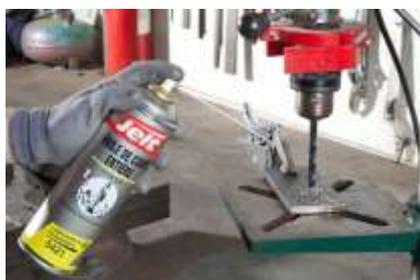
L'HUILE DE COUPE ENTIÈRE développée par ITW Spraytec sous la marque JELT est un nouveau fluide de coupe formulé à base d'huiles minérales paraffiniques et est destiné tout particulièrement aux opérations courantes en usinage comme l'alésage, le fraisage, le tournage et le décolletage.
