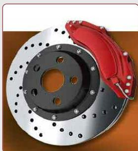
Le frein à disque est un système efficace pour tous types de véhicules réclamant un freinage performant et durand. Néanmoins, le mécanisme est soumis à rude épreuve car le frottement provoque serrage, usure et sauts de température.
