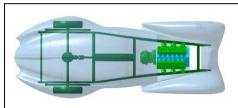
Bertrand et Basile ont du définir le châssis le mieux adapté pour la Delage. Ils sont partis du châssis long de 2m95 de la Delahaye 135 qui fut celui utilisé sur la Delage V12. Après validation par « Les Amis de Delage », les élèves ont conçu une maquette numérique de la voiture pour confirmer les degrés
