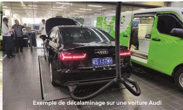
Exemple de décalaminage sur une voiture Audi
