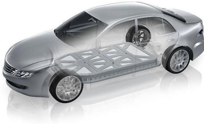
*FEV et ITL développent un prototype de logement de batterie innovant offrant de nombreux avantages grâce à l'optimisation de l'espace d'installation. Source : FEV*
