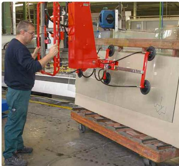
DALMEC présente sa dernière Version 2016 de manipulateurs industriels pneumatiques de type partner, équipés d'un outil de préhension à ventouses, adapté pour la prise et la manipulation de panneaux de verre aux dimensions, encombrements et poids variés (vitres, miroirs, baies, pare-brises, fenêtres, crédences).
