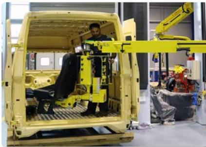
Utilisant uniquement l'air comprimé comme énergie, ce nouveau manipulateur Dalmeccan de type PARTNER EQUO en version suspendue, est capable de saisir les sièges à plat, de les manipuler, de les incliner à 90 ° grâce à un dispositif pneumatique, de les libérer en position verticale à l'intérieur du bus et de les mettre en place, grâce à un bras télescopique et à une adaptation particulière du bras terminal.
