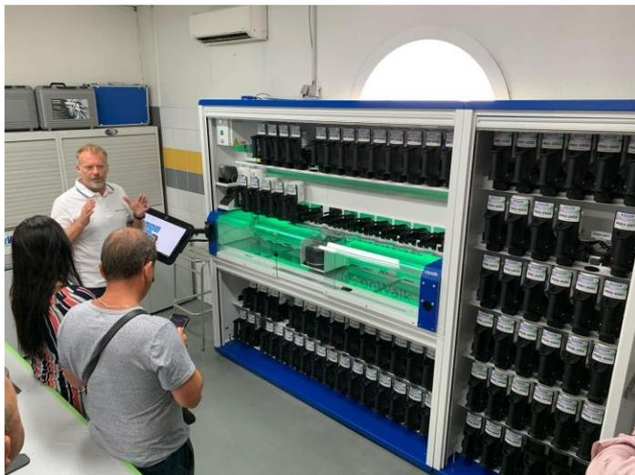
MOONWALK est un système permettant de préparer de façon automatique et autonome les teintes pour le peintre en carrosserie automobile. Cette machine à teinter inédite de PPG permet de reproduire parfaitement la teinte recherchée, même pour une très faible quantité d'usage (50 ml minimum). Compact, Moonwalk s'intègre facilement dans tous les laboratoires de carrosserie. Elle réduit les risques d'erreurs et la consommation de produit évitant ainsi gaspillage et désordre dans le
