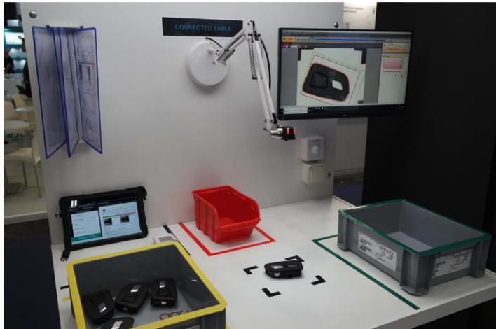
La Table Connectée est une station de contrôle complète équipée d'un capteur de vision permettant d'analyser toutes les pièces automobiles, d'un écran indiquant le niveau de conformité des pièces et d'une assistance à l'opérateur. Cette table connectée révolutionne la démarche de contrôle de qualité et de conformité car elle permet de réaliser automatiquement 12 contrôles. L'opération de contrôle
