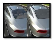
L'Intelligent Glass Control . Cette innovation permet de contrôler l'obscurcissement de la vitre en fonction du besoin, de manière automatique et manuelle. Il apporte confort en protégeant d'une trop forte luminosité et des radiations, contribue au respect de l'environnement, réduisant les CO2, améliore la sécurité en modifiant l'obscurcissement des vitres.
