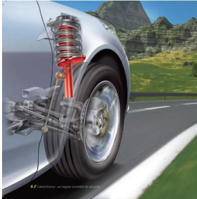
L'amortisseur absorbe les chocs dus aux déformations de la route. Il garantit donc le confort des automobilistes, mais c'est avant tout un organe essentiel de sécurité, puisqu'il maintient le contact permanent de la roue avec la chaussée. Par ailleurs, il stabilise le freinage et empêche le roulis.
