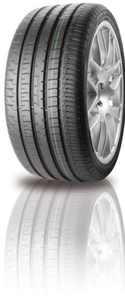
Le dessin de la bande de roulement du ZX7 présente des lamelles en 3D comportant des points d'ancrage tridimensionnels à l'intérieur de la lamelle. Les lamelles en 3D fournissent les mêmes avantages qu'une lamelle classique, et contribuent notamment à l'élévation en température plus rapide du pneu et à une meilleure adhérence sur sol humide, mais limitent surtout le niveau de flexion de la
