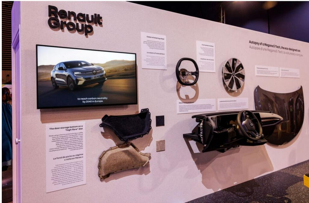
Pour preuve, l'exposition de Mégane E-TECH Electric sous la forme d'un mural proposant une vue éclatée de pièces et matières issues du recyclage. Ainsi disséqué, le véhicule révèle un capot composé jusqu'à 80% d'aluminium provenant de chutes de production recyclées en boucle fermée (soit -95% d'émissions de CO<sub>2</sub> par rapport à de l'aluminium vierge). Ou encore une planche de bord intégrant du polypropylène 100% recyclé, issu de pièces défectueuses rebroyées.
