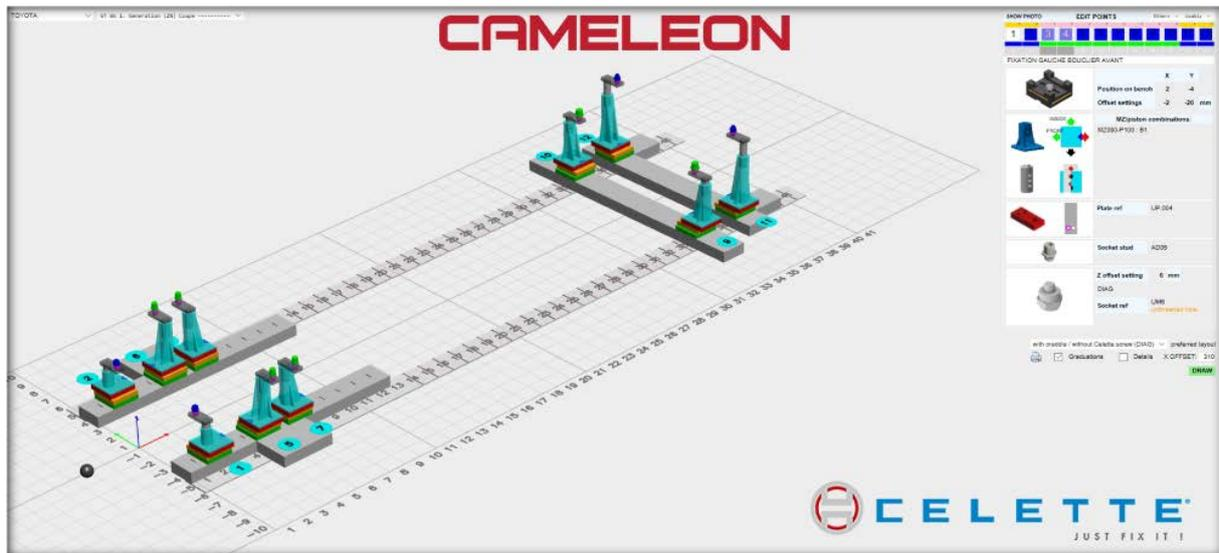
En effet, le nouveau système **Cameleon, Solution Adaptable** permet au réparateur de composer ses propres gabarits MZ+, grâce à son application internet utilisant les fiches de mesure NAJA
