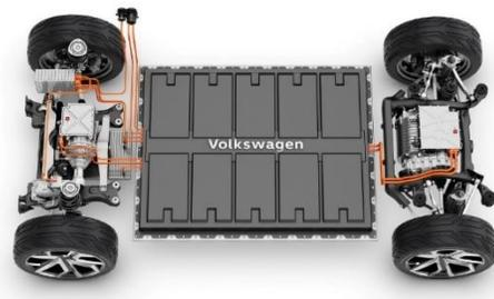
Au cœur de cette plateforme se trouve un organe essentiel, la batterie. Celle-ci a été conçue pour être totalement démontable afin que toute pièce endommagée puisse être remplacée.
