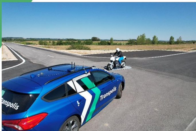
Essais ADAS avec une cible moto Euro NCAP.
